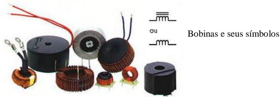
A bobina é atravessada facilmente pela corrente contínua. Corrente alternada de baixa frequência também tem facilidade para atravessar uma bobina, mas quanto maior é a frequência, maior é a dificuldade.
